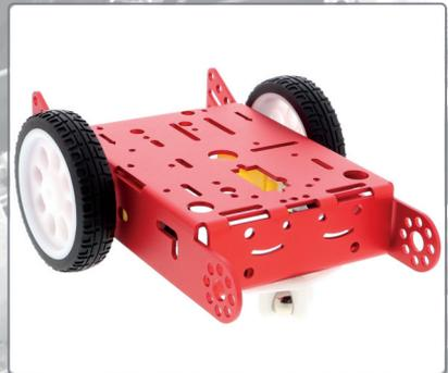
Chassis aus Aluminium mit zwei Getriebemotoren
