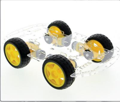
Chassis für Arduino mit zwei Achsen
