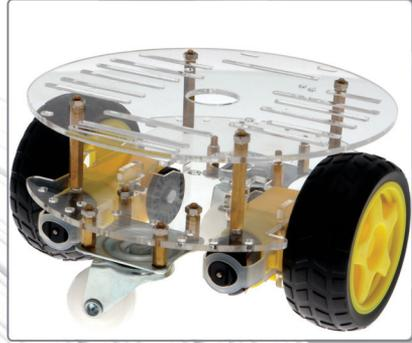
Chassis mit zwei Motoren und zwei Ebenen
