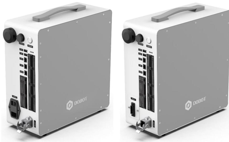
Abb. 3.5 Aussehen des Schaltschranks (links: AC-Versorgung; rechts: DC-Versorgung)
