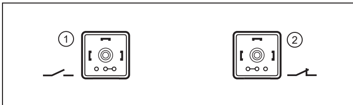
Abb. 13: Einstellen der Ausgangsfunktion über die Brücke im Stecker
